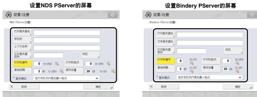
指定与在“NetWare 打印服务设置”中所指定的相同的树、上下文、文件服务器以及打印服务器名称。(根据打印服务, 设置会有所差异。有关打印服务设置, 请参阅“电子手册”>“网络”)
