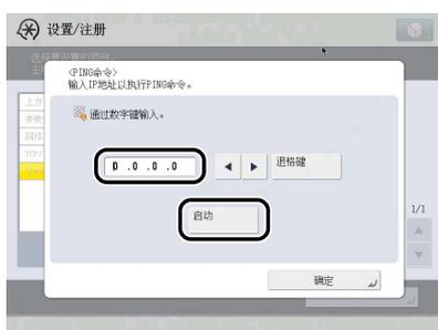
输入存在于网络上的所需 IP 地址后按 [启动] 会在触摸面板显示屏上显示 PING 命令的结果。
