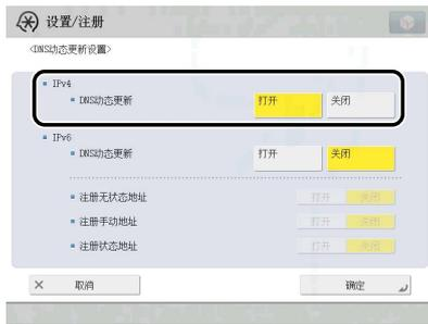
为 <DNS 动态更新 > 选择 [ 打开 ]：如果操作环境包括动态 DNS 服务器，则可以使用动态 DNS 更新在 DNS 服务器中自动注册为本机设置的 IPv4 地址、主机名和域名。
