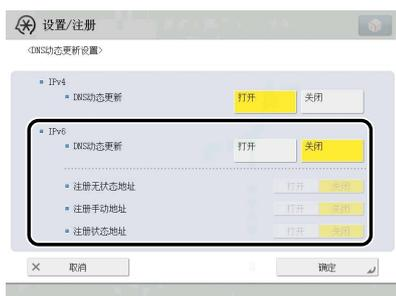
为 <DNS 动态更新> 选择 [ 打开 ]：如果操作环境包括动态 DNS 服务器，则可以使用动态 DNS 更新在 DNS 服务器中自动注册为本机设置的 IPv6 地址、主机名和域名。
