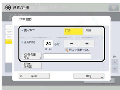
为 <使用 SNTP> 选择 [打开]：可以使用 SNTP 执行时间同步。
