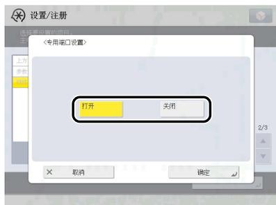
[ 打开 ]: 可以通过 Canon 打印机驱动程序或实用程序 (UFR II/PCL/PS 打印机驱动程序等) 设置或浏览本机的详细信息。
