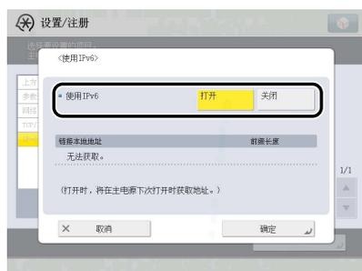
为 <使用 IPv6> 选择 [打开]：可以使用 IPv6 网络。自动设置链接本地地址。
