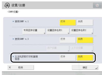
为 < 从主机获取打印机管理信息 > 选择 [ 打开 ]: 如果使用 Windows Vista 并设置 [Standard TCP/IP port] 作为打印机驱动程序端口, SNMP 端口监控功能将自动启用以获取打印机管理信息, 如有关打印应用程序和打印机端口的信息。
