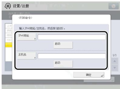
在 [IPv6 地址] 中输入存在于网络上的 IPv6 地址后按 [启动] 会在触摸面板显示屏幕上显示 PING 命令的结果。
