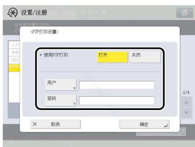
为 <使用 FTP 打印> 选择 [打开]：可以使用 FTP 作为打印应用程序。
