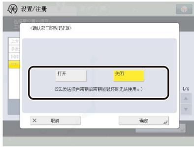
[ 打开 ]：使用支持 Windows Vista 的驱动程序进行打印时，可以确认“部门识别码”和密码。如果选择 [ 打开 ]，[ 使用 HTTP ] 自动设置为“打开”。
