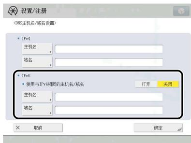
为 <使用与 IPv4 相同的主机名 / 域名> 选择 [打开]：可以为 IPv6 通信设置用于 IPv4 通信的相同主机名或域名。如果将 <使用与 IPv4 相同的主机名 / 域名> 设置为“关闭”，则在 [主机名] 中输入本机的名称并在 [域名] 中输入本机所属域的名称。如果要使用动态 DNS 更新，则必须设置主机名和域名。
