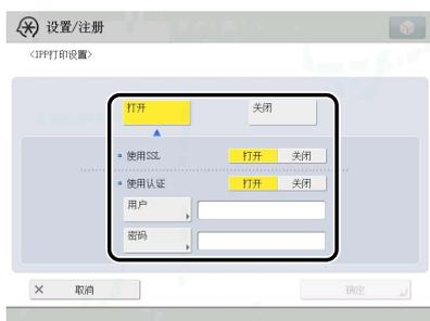
[打开]: 可以使用 IPP 作为打印应用程序。[IPP 打印设置] 按 [打开] 可以自动将 [使用 HTTP] 设置为“打开”。
