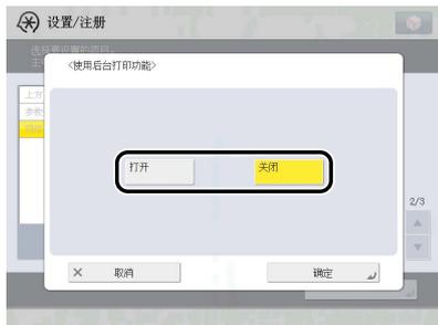
[ 打开 ]：可以在本机硬盘上对发送到本机的打印作业进行后台打印处理。
